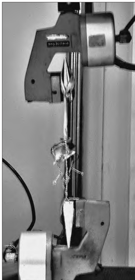
Figura 2. Anàlisi biomecànica d'una mostra amb tensiòmetre Instron.
